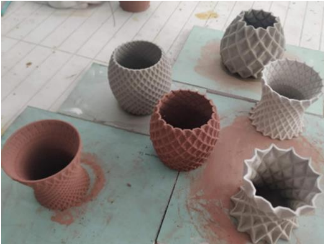
Figura 6. Diseño paramétrico y producción por impresión 3D de una serie de ocho piezas huecas tramadas en cerámica.
