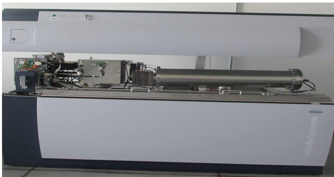
Figura 7. Espectrómetro de masas MALDI TOF/TOF
