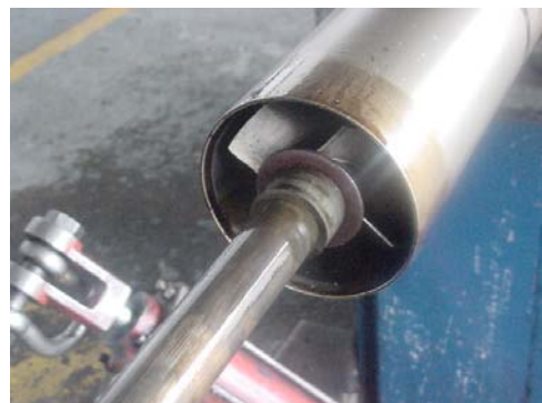
Figura 51. Separador de gas con alto desgaste abrasivo.
