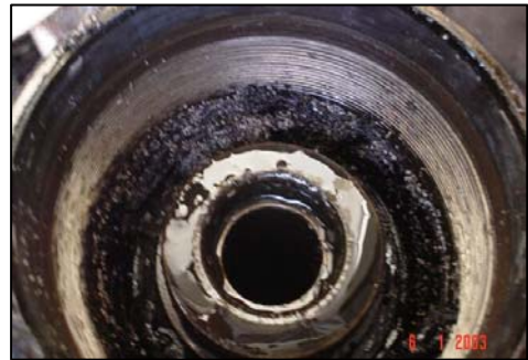
Figura 30. Acumulación de Carbolita en el protector.
