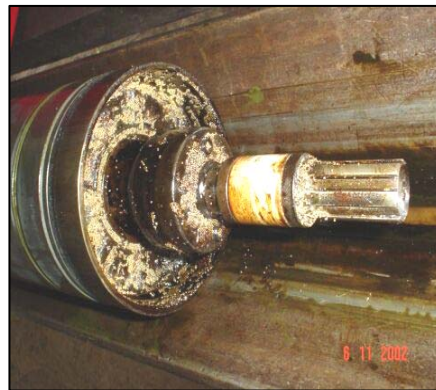
Figura 28. Presencia de sólidos en la malla tipo General Pipe.
