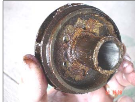
Figura 41. Acumulación de sólidos y abrasión en las etapas de la bomba.
