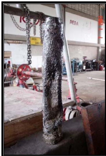
Figura 31. Estado Bolsa Protector tipo BPBSBPB.
