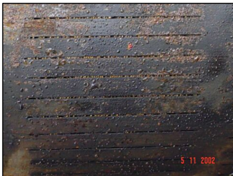
Figura 28. Presencia de sólidos en la malla tipo General Pipe.
