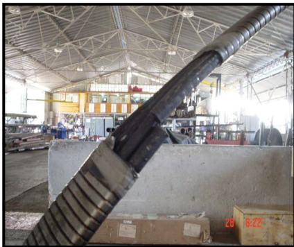
Figura 39. Fracturas en el cable de potencia.
