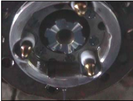
Figura 39. Fracturas en el cable de potencia.
