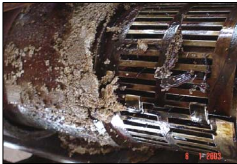
Figura 31. Estado Bolsa Protector tipo BPBSBPB.
