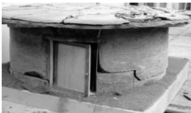
Figura 80. Ensayos sísmicos para modelos con plantas circulares. Fuente: (Minke et al. 2001).
