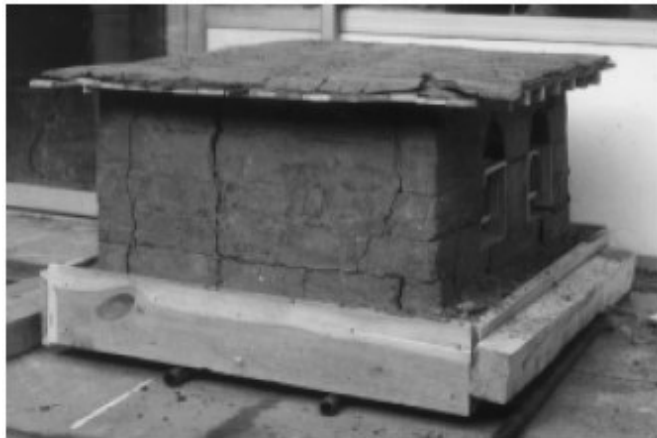
Figura 76. Ensayos sísmicos para modelos con plantas cuadradas. Fuente: (Minke et al. 2001).
