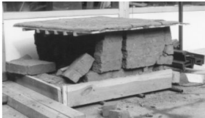
Figura 78. Ensayos sísmicos para modelos con plantas cuadradas. Fuente: (Minke et al. 2001).
