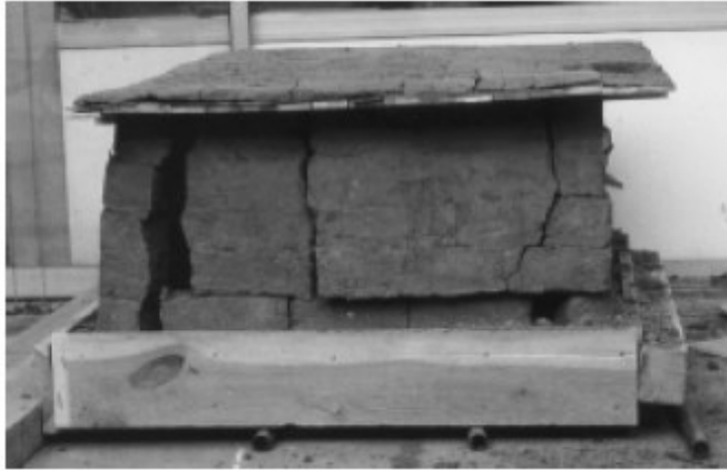
Figura 77. Ensayos sísmicos para modelos con plantas cuadradas. Fuente: (Minke et al. 2001).
