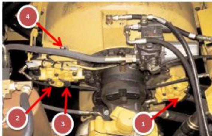
Figura 22. Subcomponentes del Sistema hidráulico del Convertidor de Torque.
