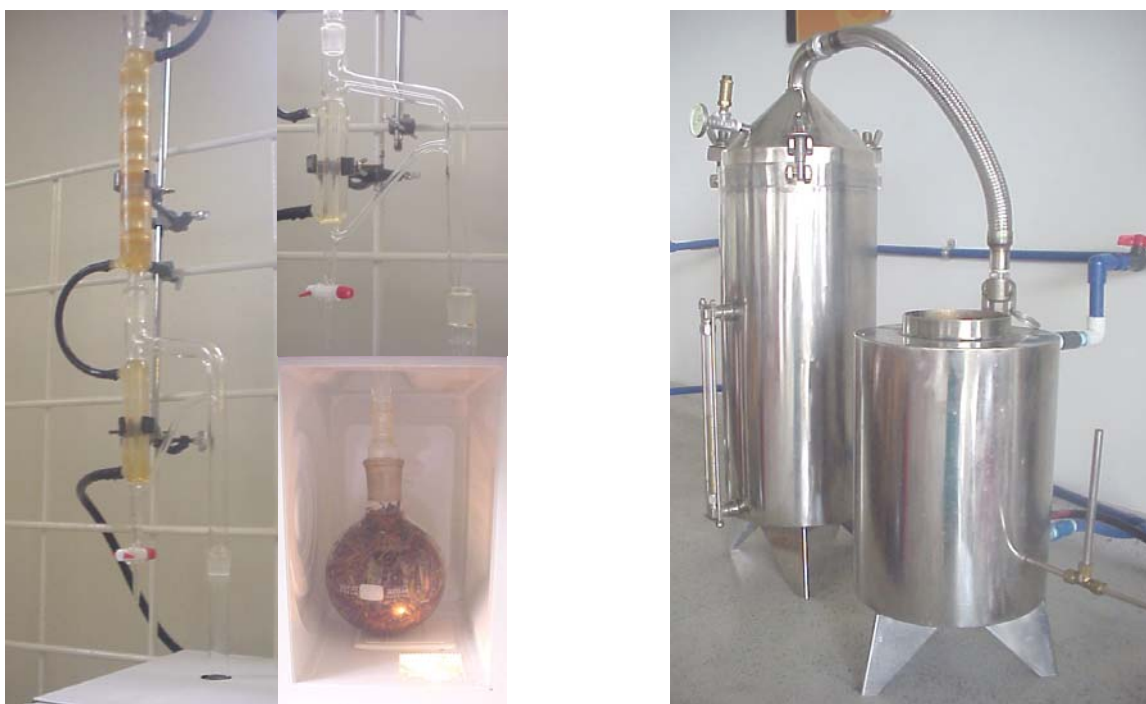
Figura 27. Equipos de extracción: A. Clevenger modificado; B. Destilador de acero semi-industrial.
