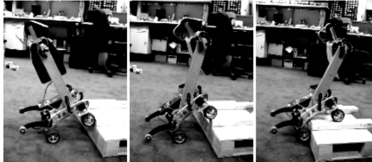
Figura 7.28: El Rover personal, demostrando escalada de obstáculos usando un cambio continuo de COM
