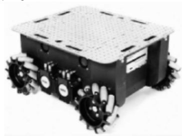
Figura 7.24: El robot Carnegie Mellon Uranus, un robot omnidireccional con cuatro ruedas suecas motorizadas de 45^\circ
