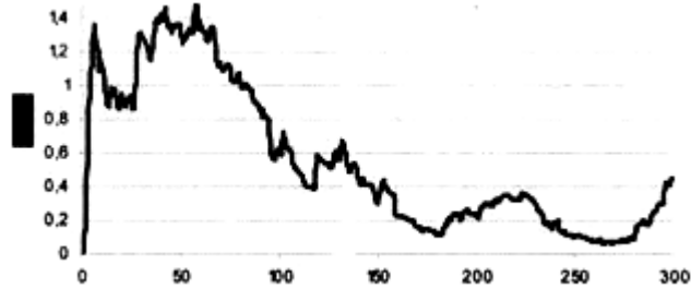
Figura 13.33: Evolución del error cuadrático medio del modelo de mundo respecto al mundo real según interactúa el robot con el mundo
