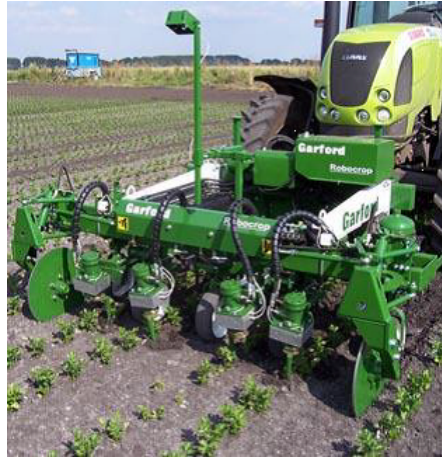
Figura 6.9: Robocrop, tractor robotizado de la empresa Tillet and Hague Technology Ltd
