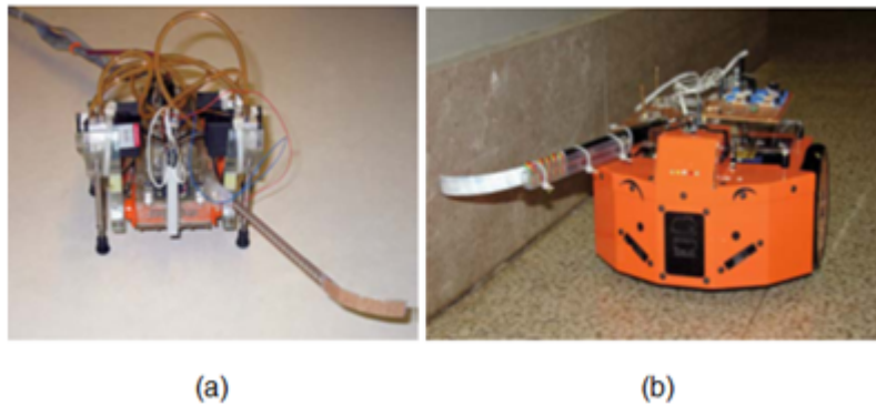
Figura 7.58: Robot Sprawlette, a) Una simple antena montada en el robot Sprawlette, b) Un dispositivo táctico más avanzado
