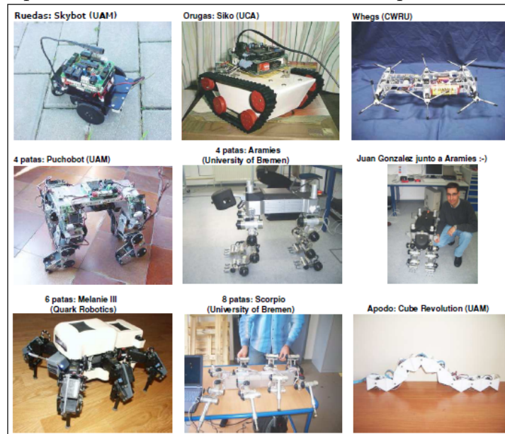
Figura 7.4: Ejemplos de robots con diferentes efectores para la locomoción terrestre
