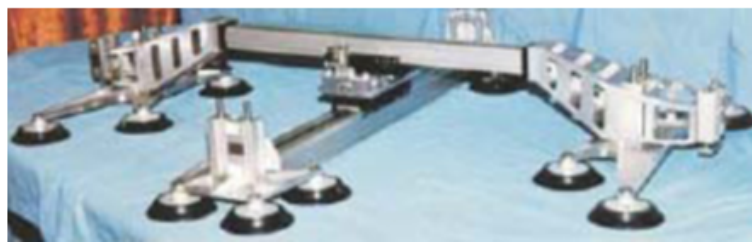
d) Mecanismo de traslación de los robots Sky cleaner 1, 2 y 3.
