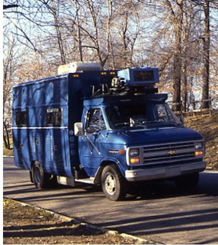
Figura 7.20: Navlab I, el primer vehículo de carretera autónomo que dirige y controla el acelerador usando sensores de visión y radar. Desarrollado en la CMU
