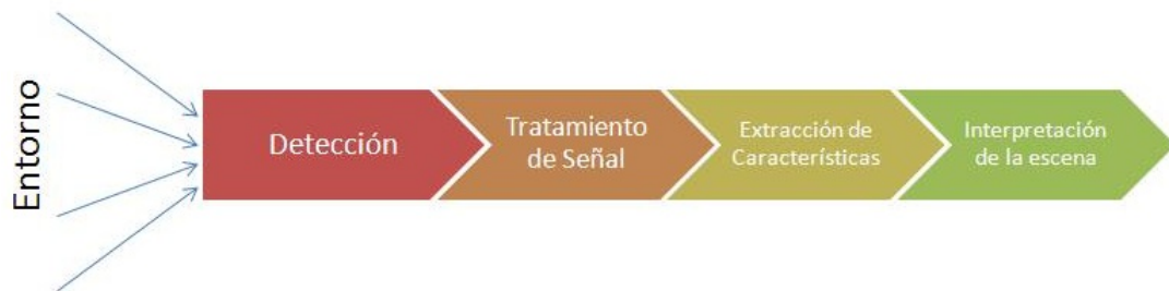
Figura 10.59: La tubería perceptual: a partir de lecturas de los sensores a modelos de conocimiento.
