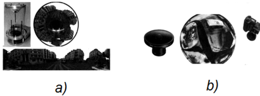
Figura 10.33: (a) Una cámara catadióptrica omnidireccional usando un espejo hiperbólico. (b) Lente de ojo de pez Nikon FC-E8.
