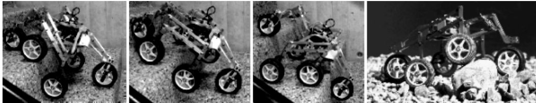
Figura 7.27: Shrimp, un robot todo terreno con excelentes habilidades pasivas de escalada (EPFL)
