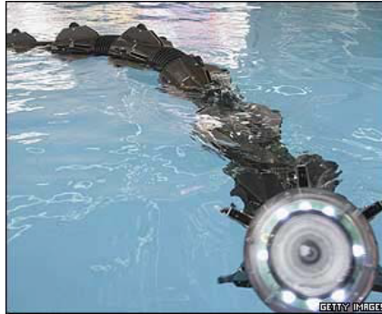
Figura 6.31: Robot marino con movimiento ondulante.
