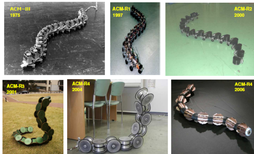
Figura 7.63: Evolución de los robots serpiente de la familia ACM (Active Cord Mechanism). Hirose-Fukushima Robotics Lab
