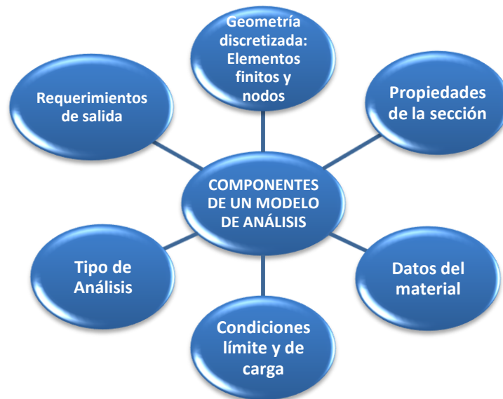
Figura 15. Esquema general de los componentes de un modelo de análisis.
