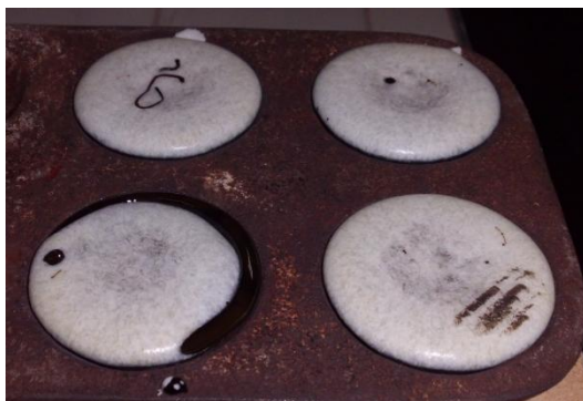
Figura 14. Escoria de MR obtenida del ensayo con el método de litargirio-nitro, después de la colada y antes de la separación de fases.
