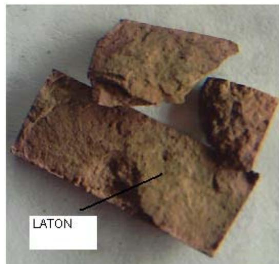
**FIG 7.2 GRIETA LONGITUDINAL Y CAPA SUPERFICIAL DE COLOR AMARILLO**
