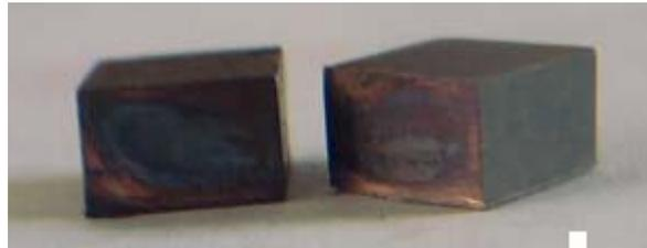
**FIG 7.3 COBRE CON ALUMINA ALEADO MECANICAMENTE**
