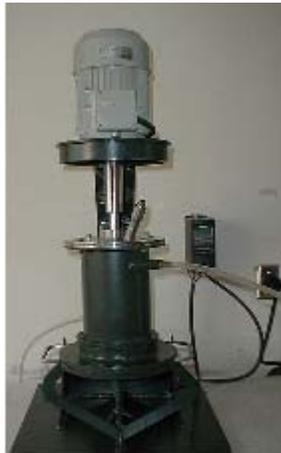
**FIG 6.3 VISTA FRONTAL MOLINO ATRITOR (CORTESIA GRUPO INVESTIGACION DE CORROSION UIS)**
