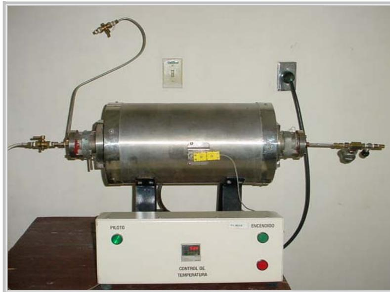
FIG 6.5 HORNO DE SINTERIZACION ( CORTESIA GRUPO INVESTIGACION DE CORROSION UIS)
