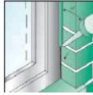
Figura 38. Aplicación de sello para dilataciones.
