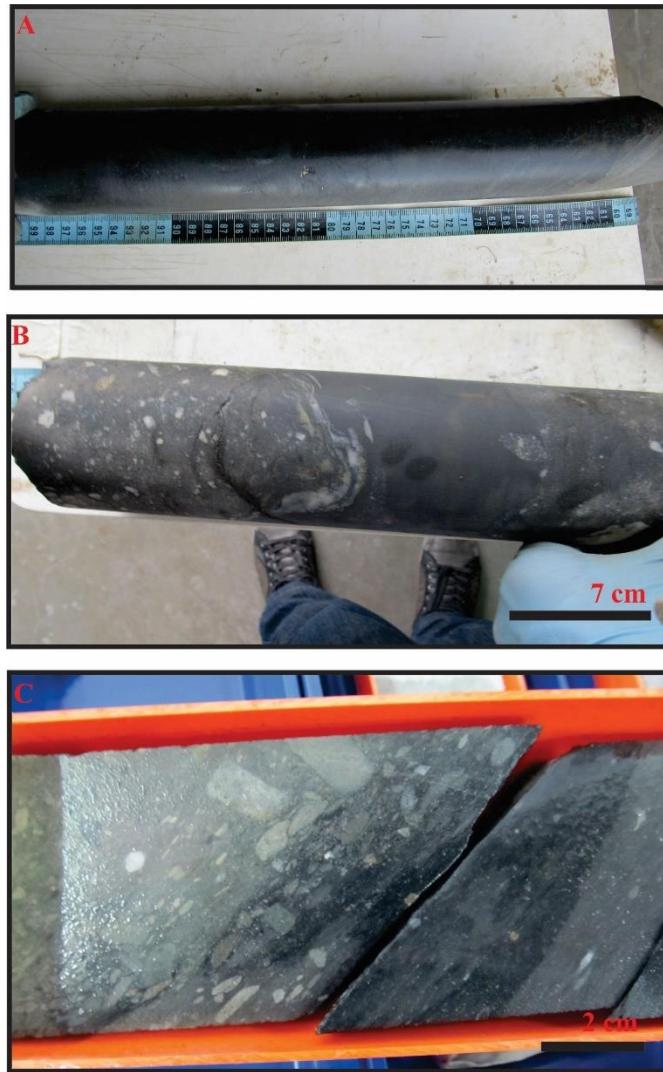
Figura 14. Fotografías de núcleos del pozo UBL0809 sobre niveles arcillolíticos. A) Arcillolita negra bien cementada. B) Lente de arcillolita entre el conglomerado. C) Contacto transicional entre la arcillolita y el conglomerado.
