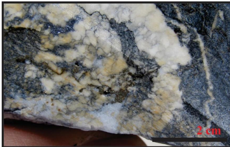
Figura 16. Fotografía de núcleo del pozo UBL0809 mostrando un relleno hidrotermal de ankerita-siderita-galena-pirita-cuarzo.
