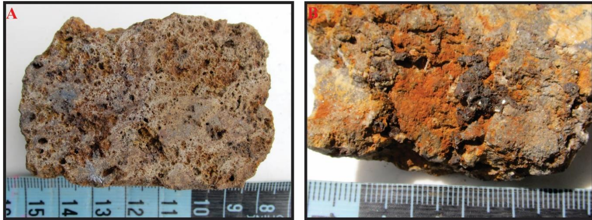
Figura 17. Fotografías de la limonita-gossan en núcleos del pozo UBL0809. A) Textura porosa de óxidos con anglesita en color gris B). Colores anaranjados fuertes de óxidos hidróxidos.
