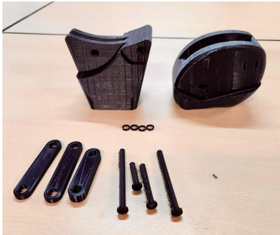
Figura 39. Mecanismo 3D, PLA con 10% de relleno
