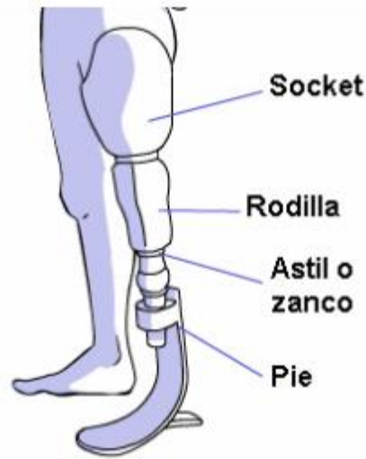
Figura 15. Esquema de prótesis transfemoral y sus partes.
