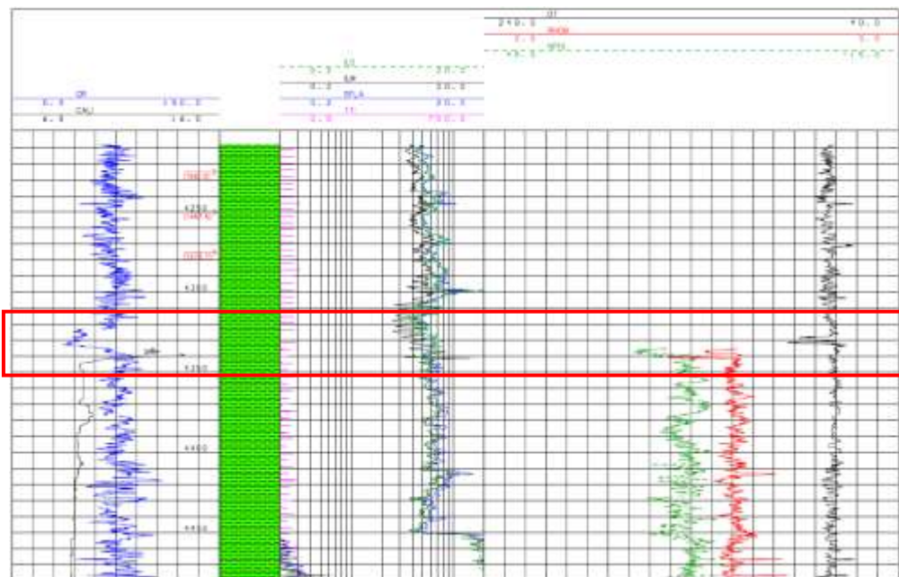
Figura 4. Set de registros de un pozo que muestra incongruencia (@ 4310 – 4350 m) entre la lectura del registro GR y su interpretación litológica, pues los valores de GR para este intervalo no corresponden a los de una arcillolita shale.
