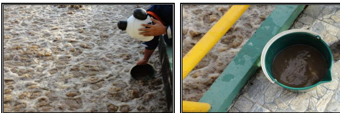
Figura No. 15 Recolección de muestra de lodos presentes en los filtros.
