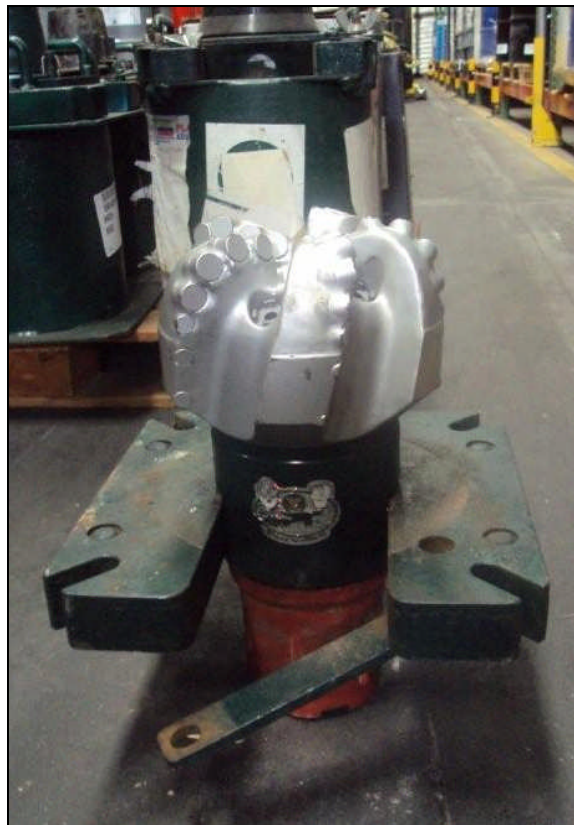
Figura 13. Broca Tipo PDC de cinco aletas
