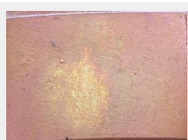
Sulfuro de potasio y agua caliente. 10 días Se le agrega sal a la sustancia inicial. 3 días
