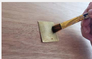
Figura 35 Limpieza química de la superficie del metal
