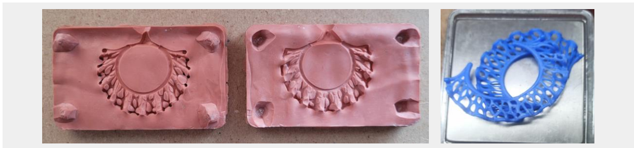
Figura 72 Molde en caucho y replicas en cera del par de aretes
