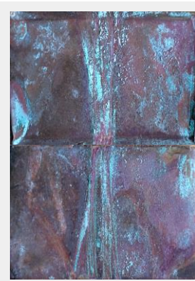
Sulfuro de potasio y agua caliente. 10 días Se le agrega sal a la sustancia inicial. 3 días
