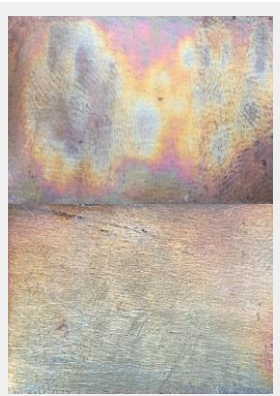
Lámina calentada con soplete sobre sulfato de potasio. 2 min
