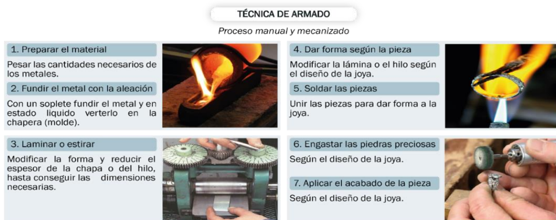
Figura 2 Estructura básica de la técnica de armado
