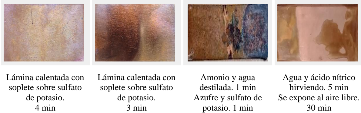
Figura 40 Espectro de la coloración en el cobre
