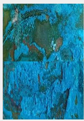
Ácido fosfórico. Sulfato de cobre- cloruro de sodio y ácido acético. 24 h Acetona. Cloruro de amonio y agua destilada. 3 días
