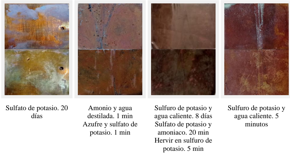
Figura 38 Espectro de la coloración en el latón
