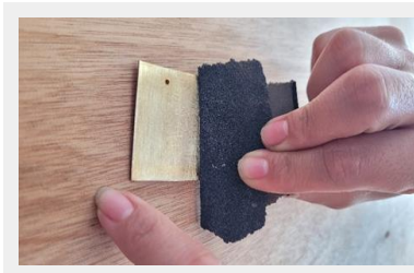
Figura 34 Limpieza mecánica de la superficie del metal
