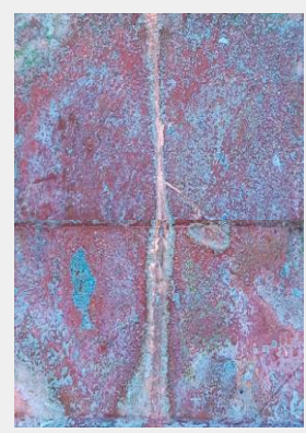
Sulfuro de potasio y agua caliente. Se bate la sustancia diariamente. 10 días
