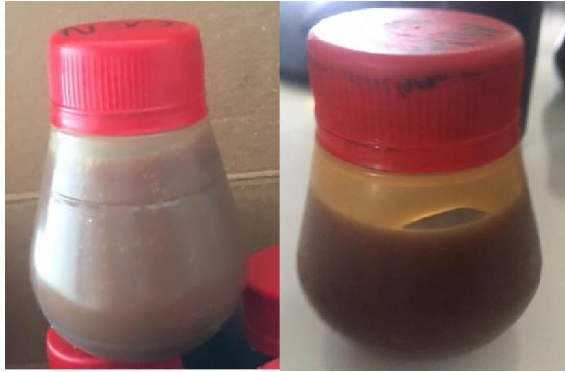
Figura 20. Muestra de lubricantes tomadas en fase emulsificador.
