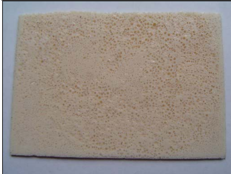
Figura 23. Polímero obtenido sin aplicar vacío al prepolímero.
