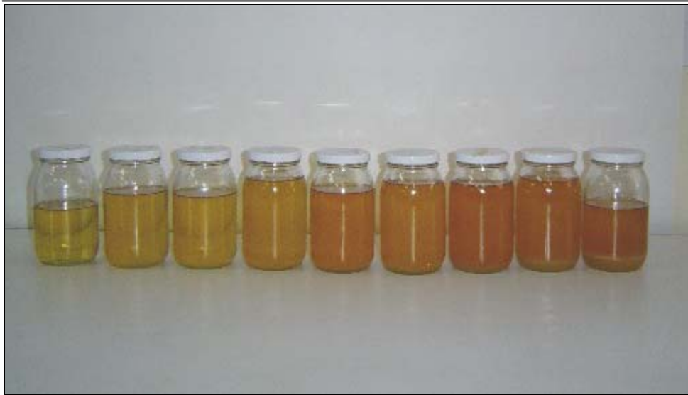
Figura 19. Polioles obtenidos con la variación de la cantidad de pentaeritritol para modificar el aceite de higuera
