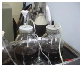
Figura 3. Biorreactor para bioaumentación de los microorganismos
