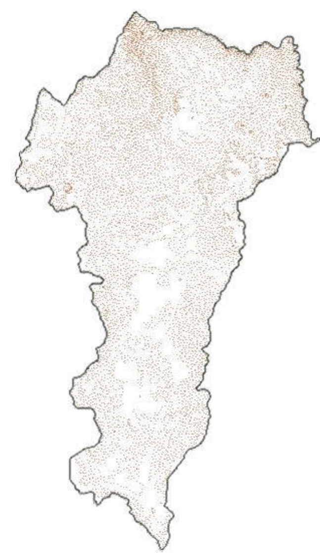
Figura 34. Plano de puntos cada 200 m para interpolar MDE.
