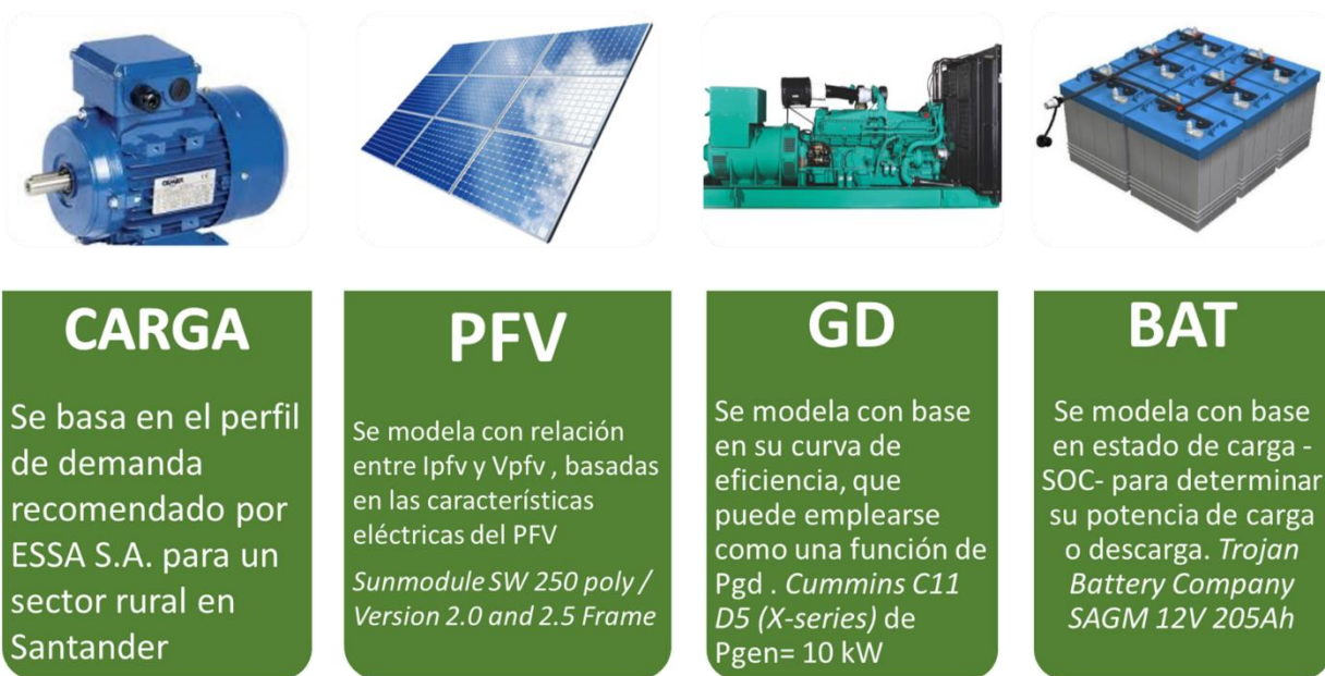
Figura 13. Topología para integración de etapas en una nanored con fuentes PFV-GD-BAT
