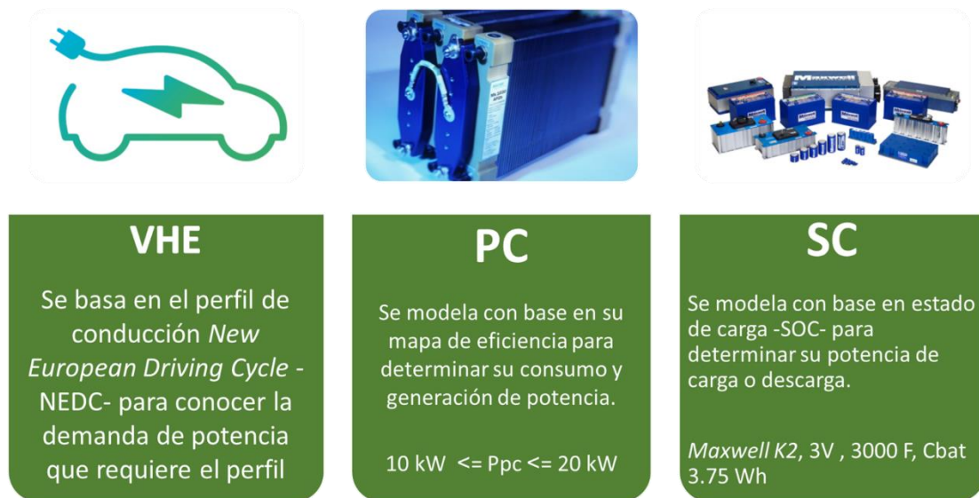
Figura 4. Topología del caso de estudio del VEH con PC+SC
