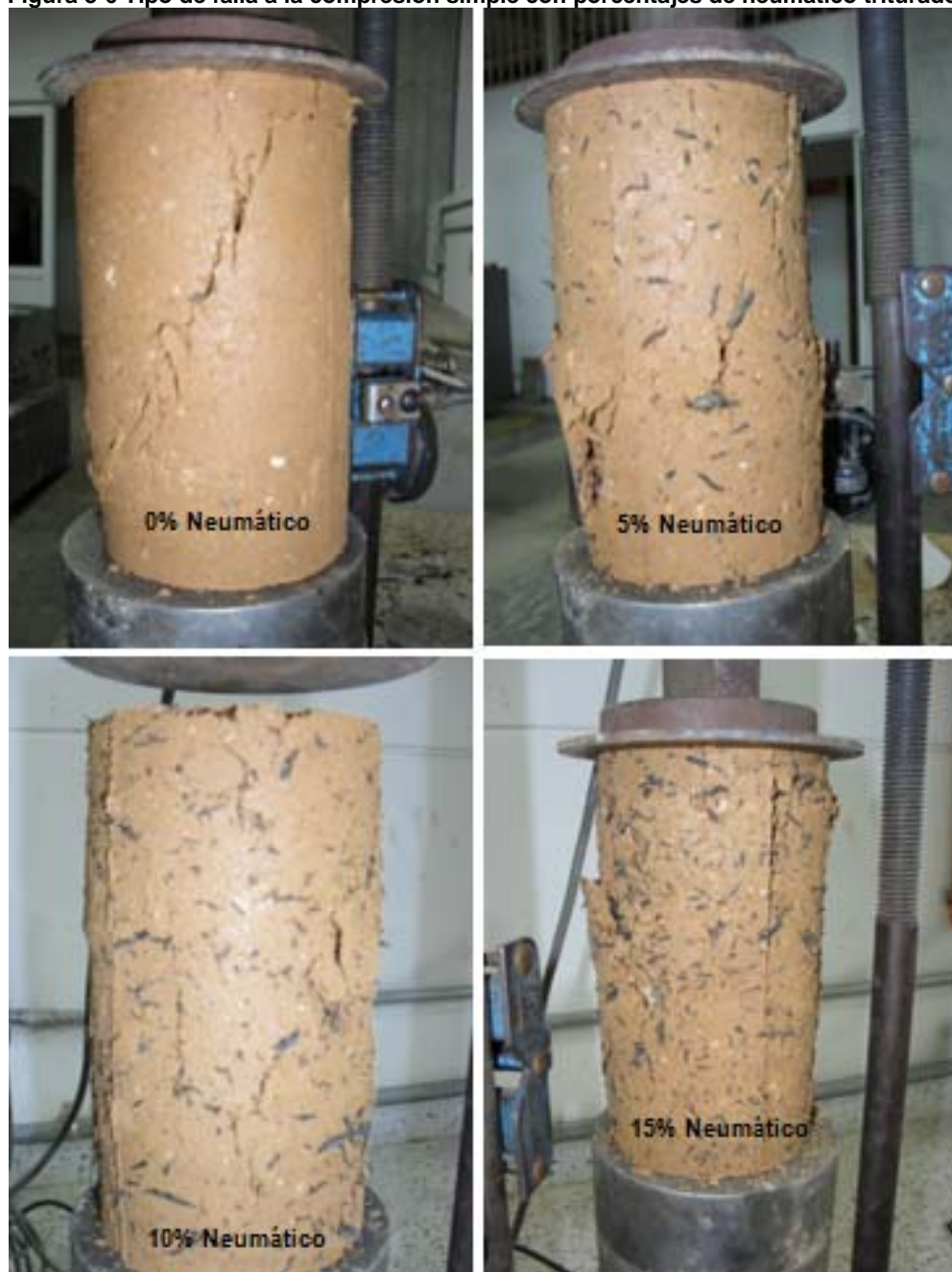
Figura 3-6 Tipo de falla a la compresión simple con porcentajes de neumático triturado.
