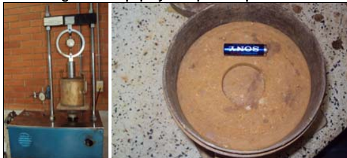
Figura 2-8 Equipo y falla probeta para CBR.
