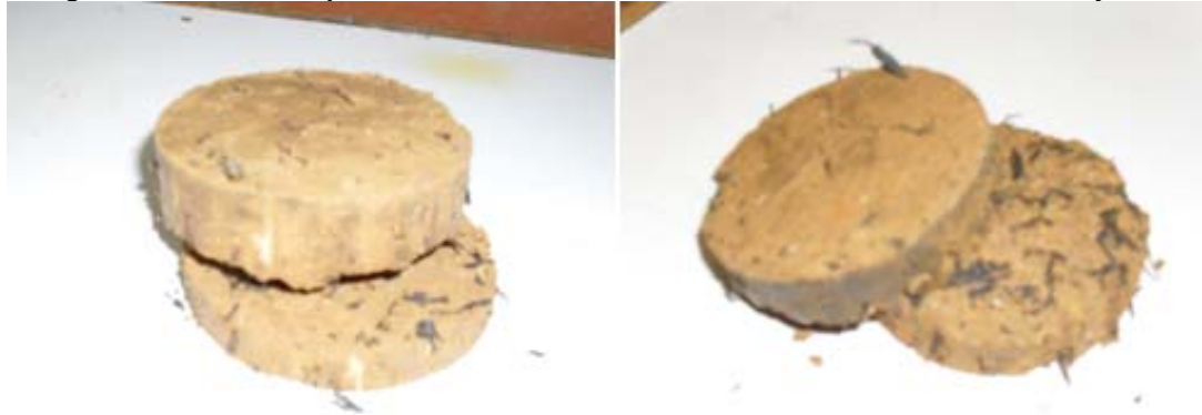
Figura 3-8 Falla de las probetas de corte directo de la mezcla suelo – neumático 10 y 15%
