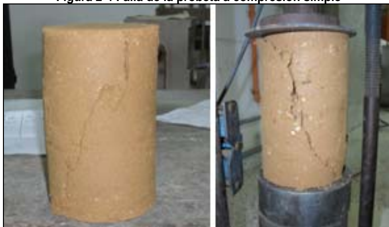
Figura 2-4 Falla de la probeta a compresión simple
