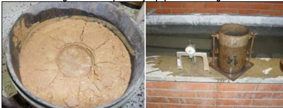
Figura 2-9 Falla probeta y equipo CBR sumergido
