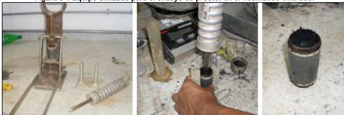
Figura 3-1 Equipo utilizado para el ensayo de proctor en el neumático triturado.
