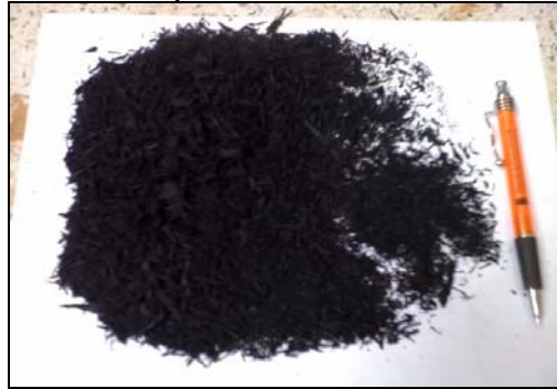
Figura 1-10 Material resultado del raspado de la banda de rodamiento del neumático
