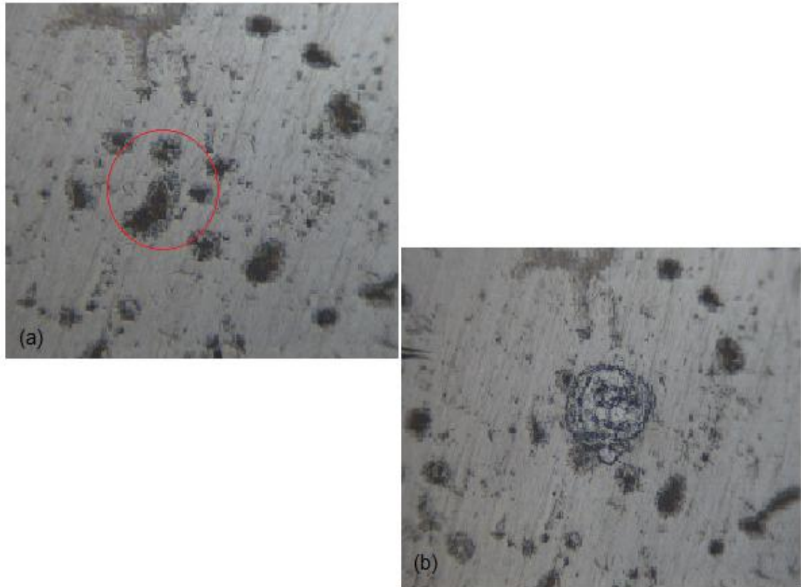
Figura 25. Fotografía microscópica del acero HP-40 a 40x, muestra TSEC 863A1 proveniente de la zona E (ver figura 5). (a) Zona con precipitaciones. (b) cráter formado después del disparo láser sobre la precipitación.
