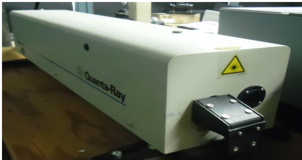
Figura 7. Láser pulsado Nd: YAG, Ubicado en el laboratorio de espectroscopia Atómica y Molecular (LEAM-UIS)
