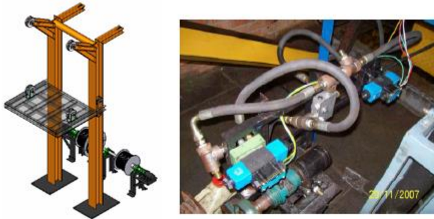
Figura 8. Estructura y sistema hidráulico del primer banco
