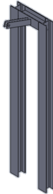
Figura 14. Estructura con apoyo superior.
