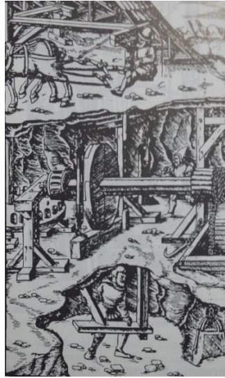
Figura 6. Elevador accionado por tracción animal
