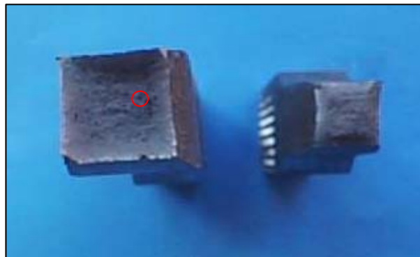
Figura 26. Superficie de fractura de cono y copa de la probeta 28210 (F)
