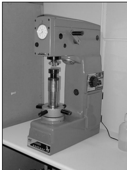
Figura 7. Durómetro para medida de dureza Rockwell
