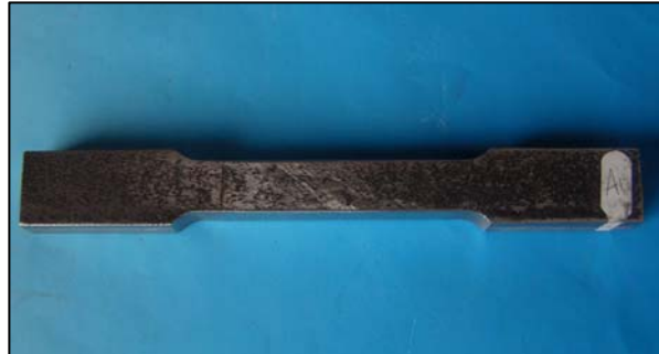
Figura 19. Probeta de tracción suministrada por el fabricante
