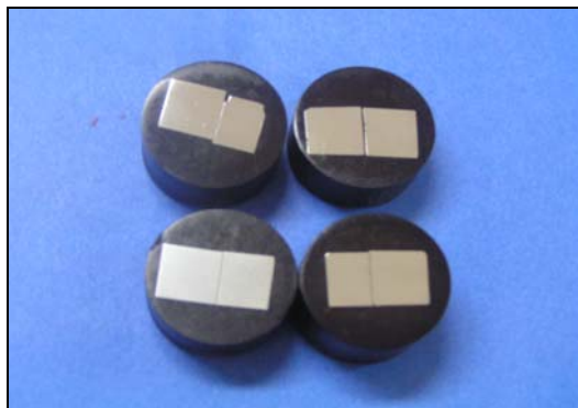
Figura 18. Probetas montadas en baquelita
