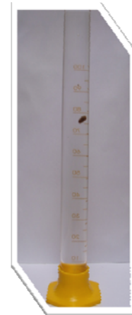
Figura 21. Resultado Prueba de Mojabilidad Arena Mojada por Varsol (60% en volumen) +Xileno (40% en volumen) Arena Floclada en Salmuera. Fuente: El Autor
