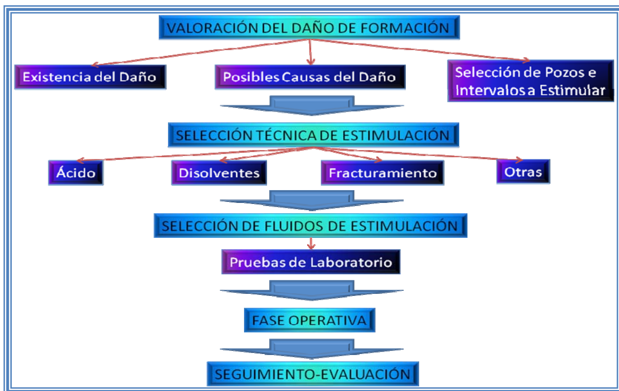
Figura 29. Metodología para la Realización de Trabajos de Estimulación
