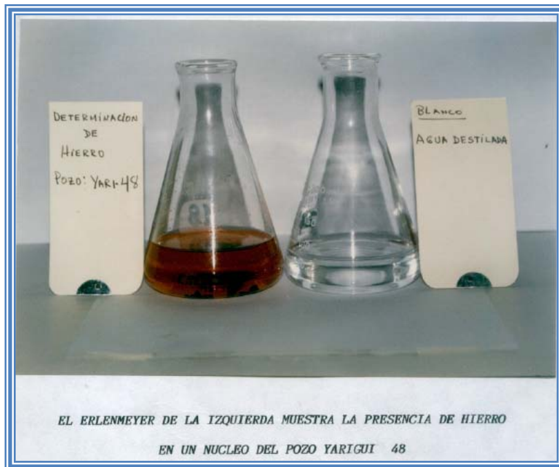
Figura 31. Presencia de Compuestos de Hierro en Núcleo YR 48
