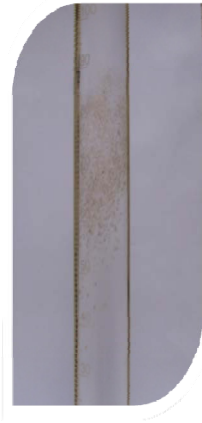
Figura 23. Resultado Prueba de Mojabilidad Arena Mojada por Varsol (60% en volumen) +xileno (40% en volumen) + PET 55 (5% en volumen) Arena Dispersa en Varsol. Fuente: El Autor
