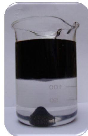
Figura 24. Resultado Prueba de Detergencia. Arena Mojada por Varsol (60% en volumen) +xileno (40% en volumen) No detergencia. Fuente: El Autor
