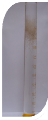
Figura 22. Resultado Prueba de Mojabilidad Arena Mojada por Varsol (60% en volumen) +xileno (40% en volumen) + PET 55 (5% en volumen) Arena Dispersa en Salmuera. Fuente: El Autor
