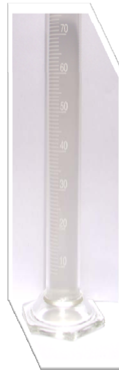
Figura 19. Resultado Prueba de Solubilidad Varsol (60% en volumen) +xileno (40% en volumen) + PET 55 (5% en volumen)
