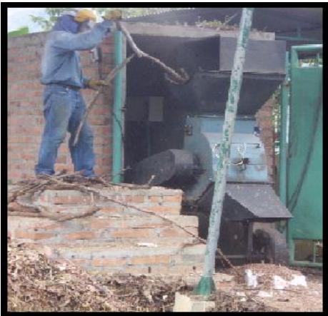
Figura 3. Molino de martillo en proceso de trituración.
