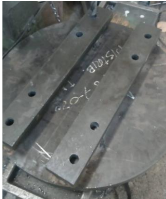
Figura 84. Disco macizo y placas guía del sistema de agarre trasero
