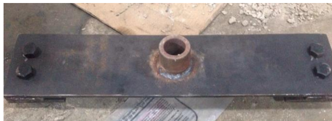
Figura 73. Agarre del sistema de soporte para los cilindros a la estructura base
