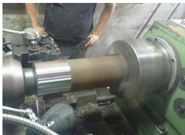
Figura 78. Mecanizado del tubo de transmisión
