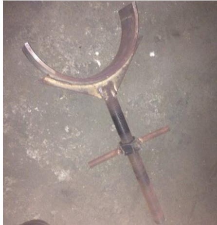
Figura 72. Sistema de soporte para los cilindros
