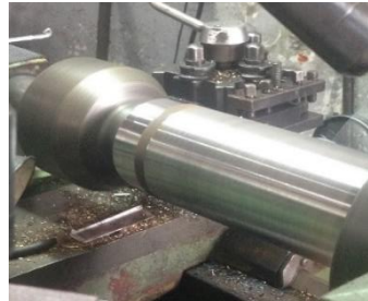
Figura 78. Mecanizado del tubo de transmisión
