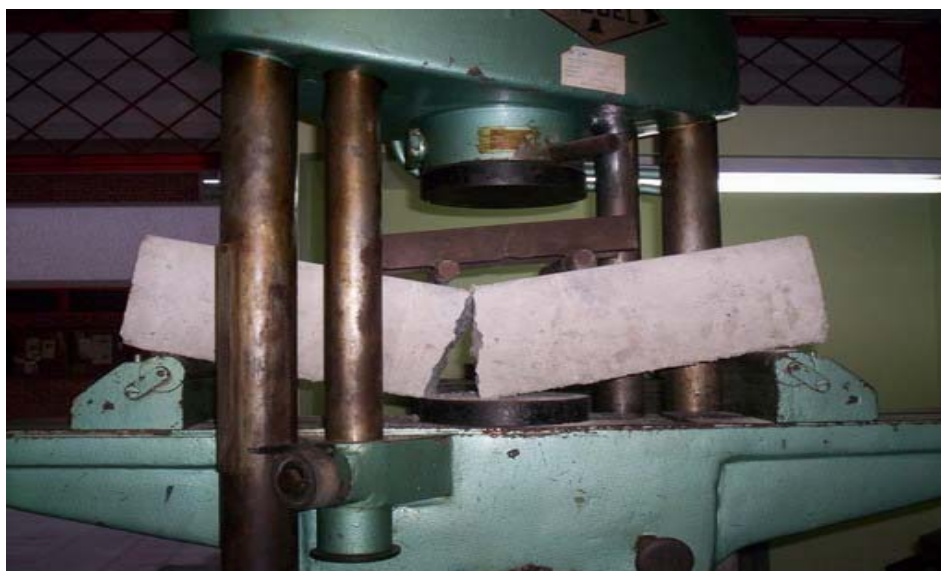
Foto 21. Probeta fallada a Flexión
