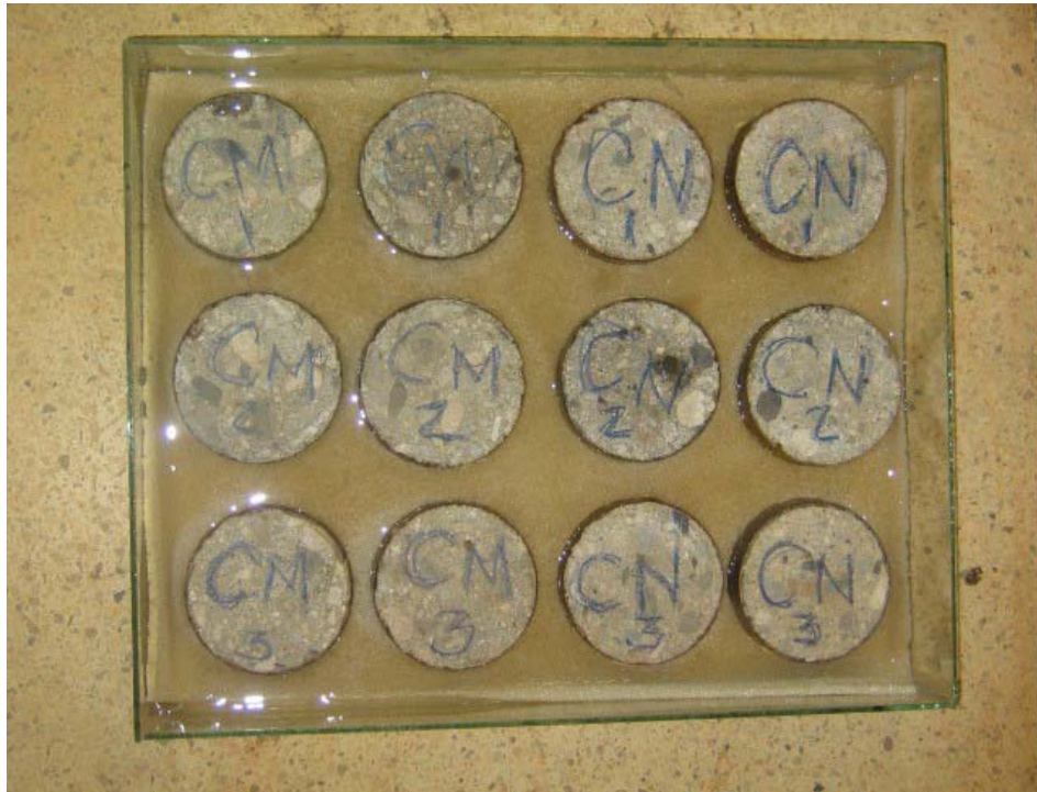
Foto 14. Montaje ensayo de absorción capilar
