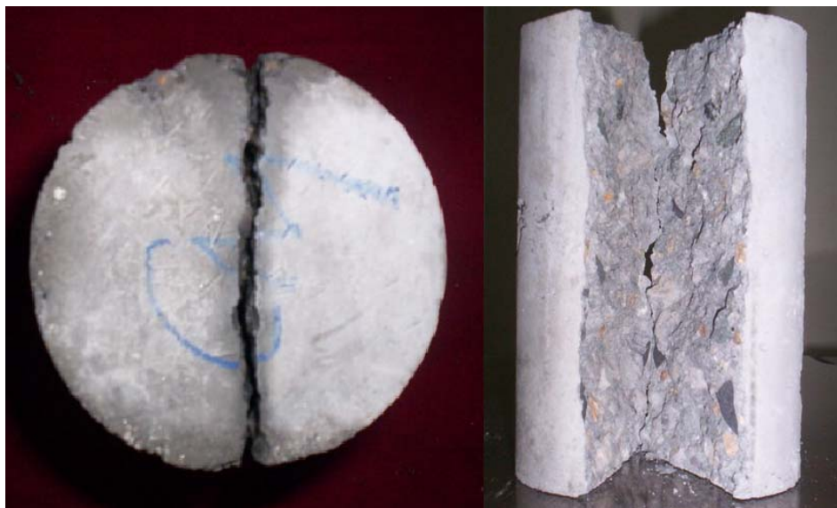
Foto 20. Probetas falladas a Tensión por compresión diametral
