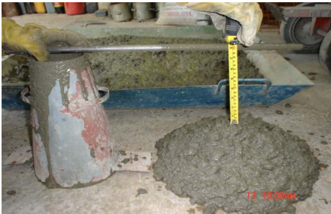
Foto 4. Asentamiento de la mezcla de concreto modificado
