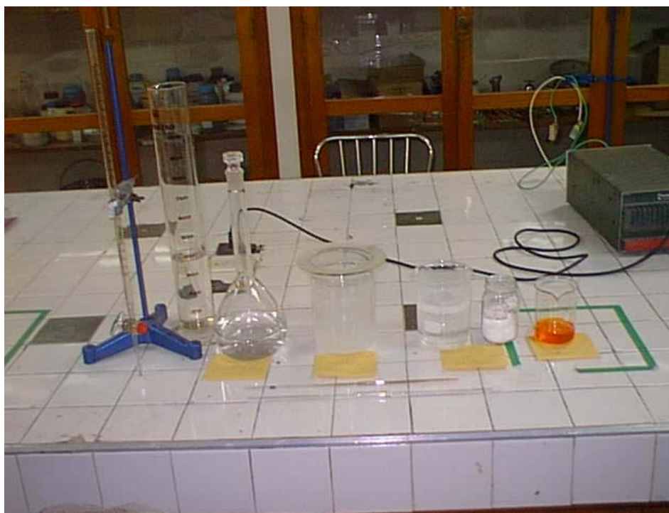
Foto 16. Soluciones utilizadas prueba de difusión de cloruros y montaje titulación
