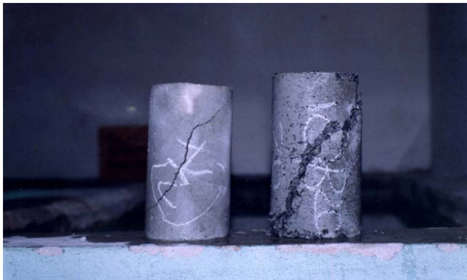
Foto 19. Probetas falladas a Compresión
