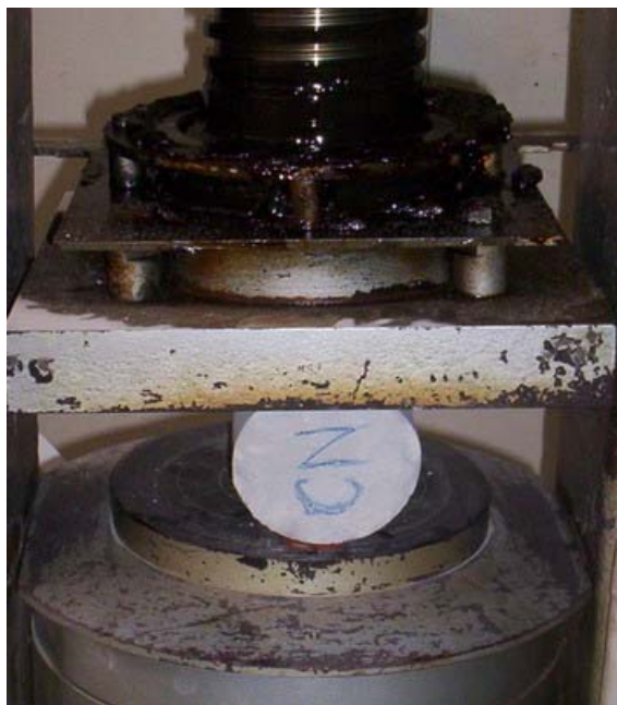
Foto 8. Montaje de ensayo a tracción
