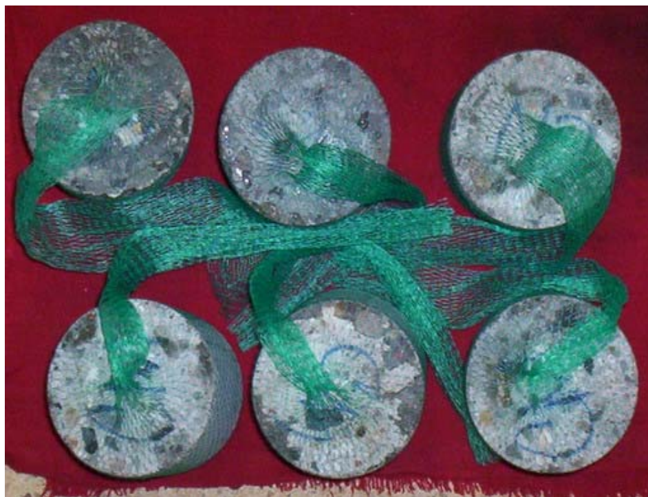
Foto 17. Probeta ensayo de solidez a sulfatos para inmersión
