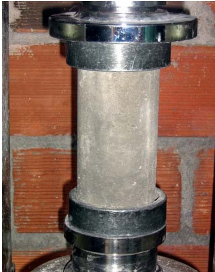
Foto 6. Montaje de ensayo a compresión
