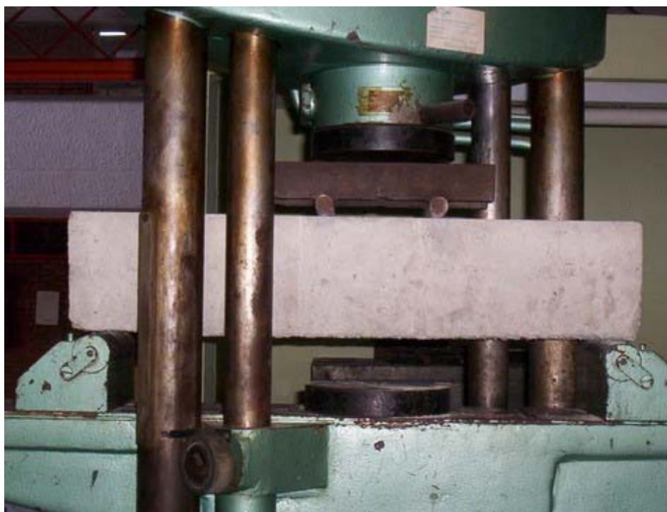
Foto 10. Montaje de ensayo a flexión
