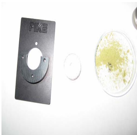
FIGURA 19 Preparación de pastilla para IR
