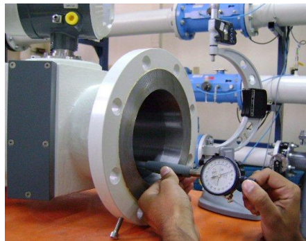
Figura 21. Medición del Diámetro Interno del Medidor Ultrasónico
