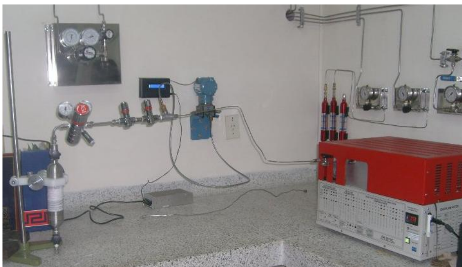
Figura 23. Análisis Cromatógrafico de Una Muestra de Gas Natural
