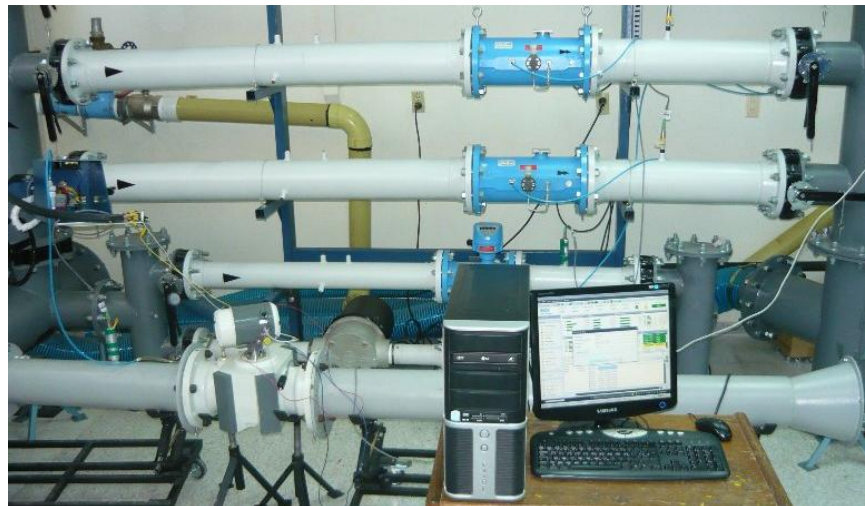
Figura 19. Montaje de USM Para Tomada de Datos Experimentales Con Aire a Condiciones de Flujo
