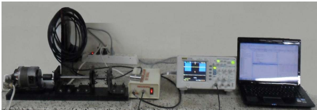
Figura 25. Instrumentación utilizada en la técnica de EA (Conexión sistema de adquisición)
