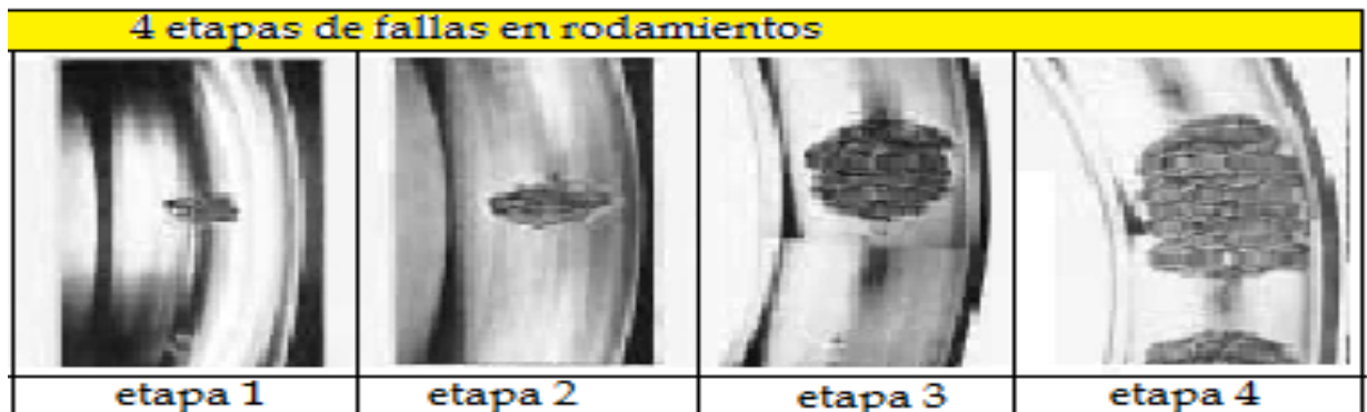
Figura 7. Etapas de falla en rodamientos
