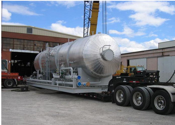
Figura 39. Tratador electrostático horizontal para el desalado del crudo.
