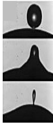
Figura 79. Gotas de 500 \mu\text{m} cayendo, coalesciendo, y formando una gota satélite.
