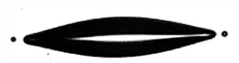
Figura 72. Inestabilidad de gota tipo I: Expulsión de pequeñas gotas individuales.
