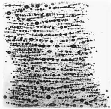
Figura 66. Formación de cadenas en un líquido inactivo a partir de un campo eléctrico horizontal.
