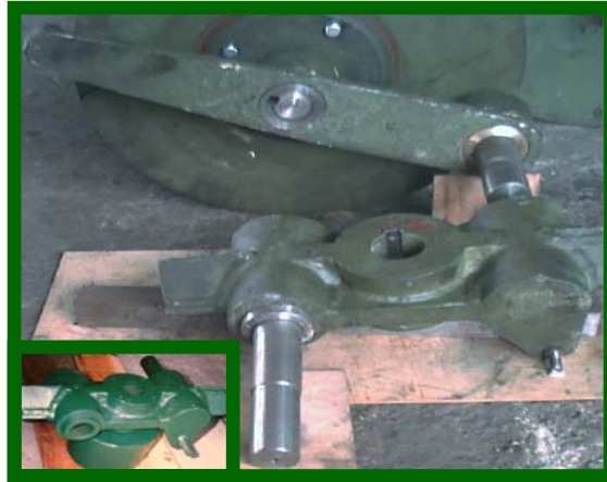
Figura 47. Montaje del soporte central.
