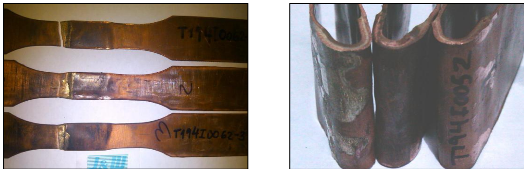
Figura 22. Muestras falladas en la prueba de tensión y doblez guiado
