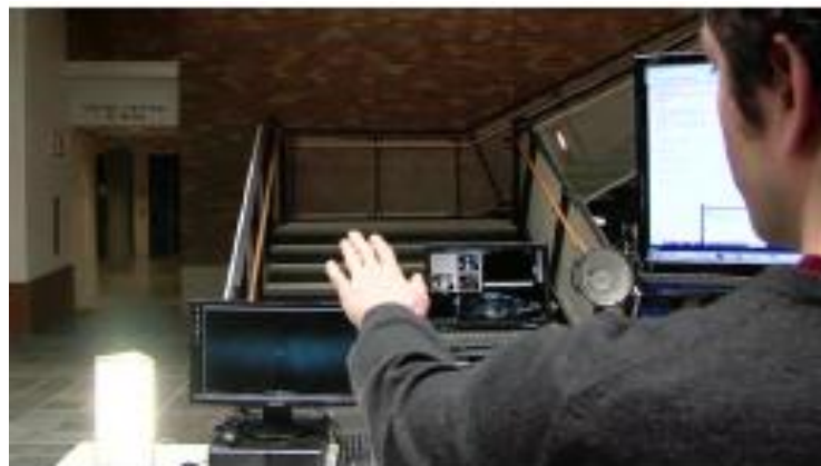
Figura 32. Interacción en control de iluminación mediante gestos [169].
