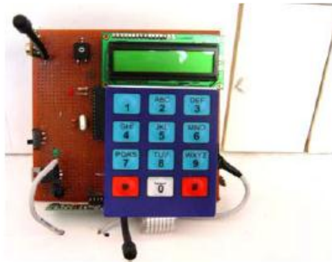
Figura 26. Implementación del nodo de bloqueo de puerta [86].
