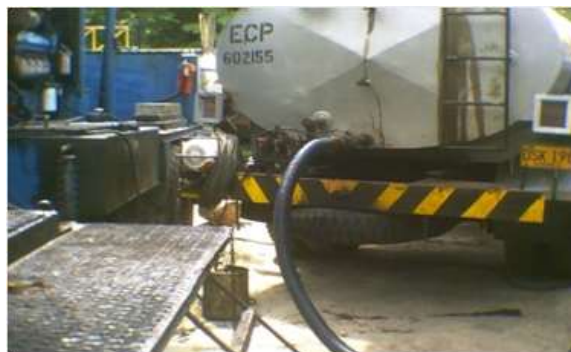
Figura 7. Línea de descarga del carro-tanque.
