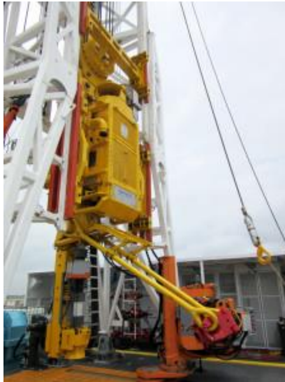
Figura 16. Elevador de Top Drive en extensión para subir herramientas de la planchada a la mesa.
