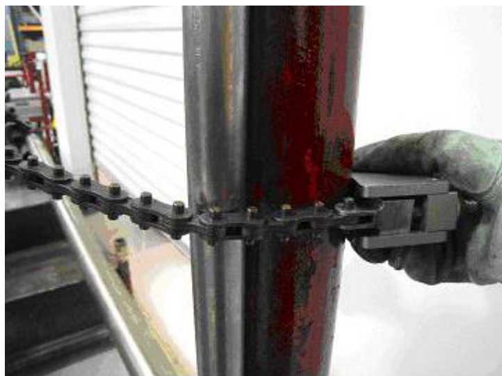
Figura 11. Surface Wireless Tool enganchada a tubería. Fuente Halliburton
