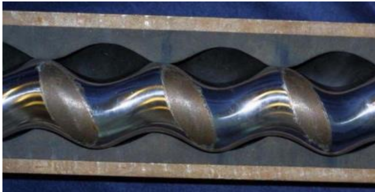
Figura 30.Desgaste abrasivo sobre el rotor.
