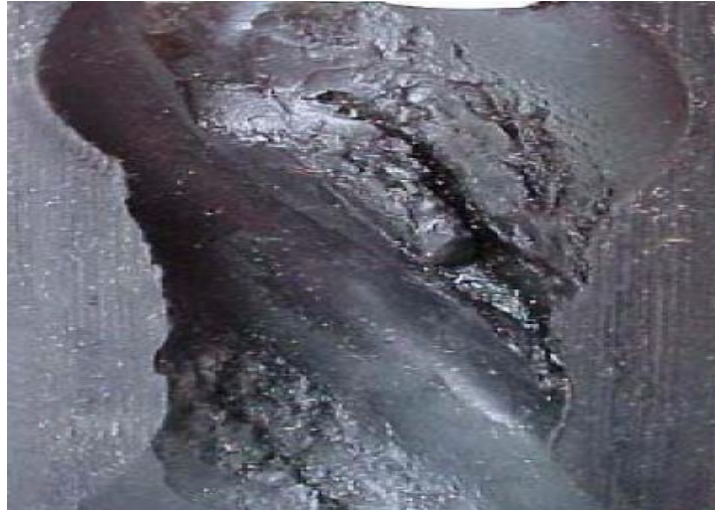
Figura 27. Elastómero dañado por altas temperaturas.
