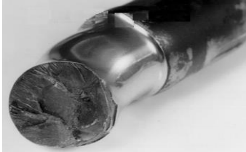
Figura 32. Falla por torsión en el rotor.
