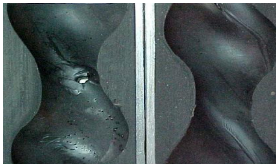
Figura 29. Elastómero dañado por la abrasión.
