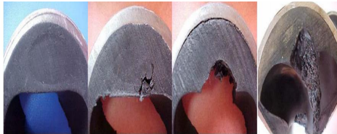
Figura 28. Secuencia de falla en un elastómero, debido a la histéresis.
