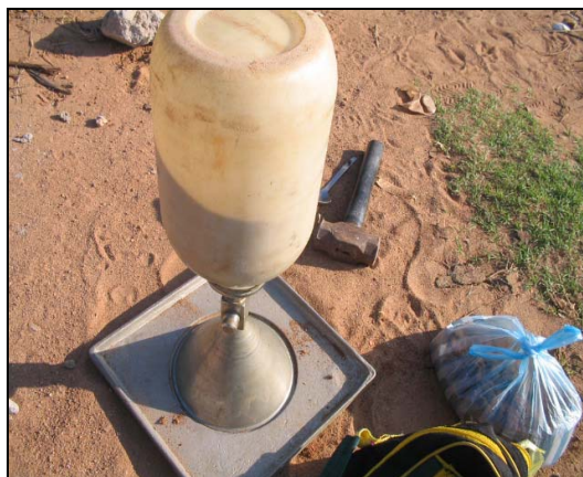
Figura 14. Equipo de Densidad de Cono de Arena
