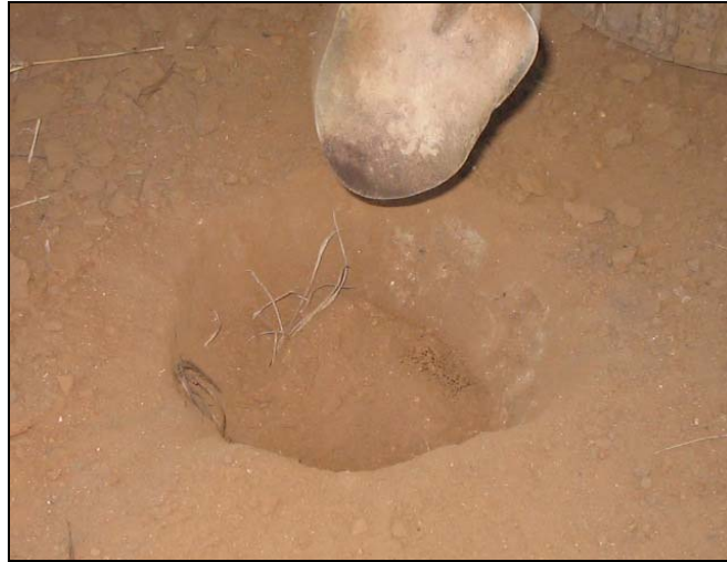
Figura 23. Apíque para el ensayo de CBR in situ a 15 cm del punto de realización del ensayo de cono de arena
