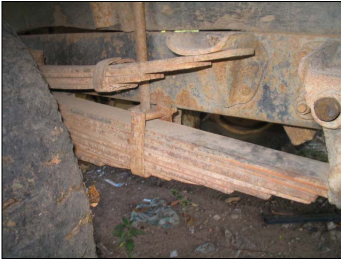
Figura 20. Estado de los muelles antes de levantar la camioneta
