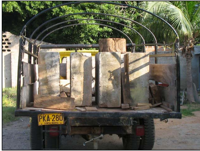
Figura 18. Bloques de concreto de 1 x 1 x 0.35 m.
