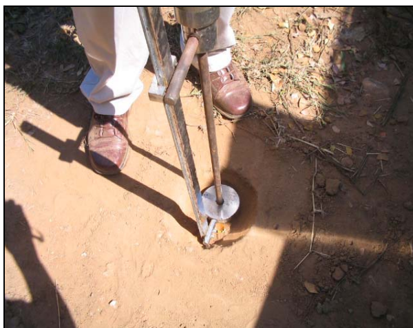
Figura 26. Ensayo de DCP dentro del apíque del CBR
