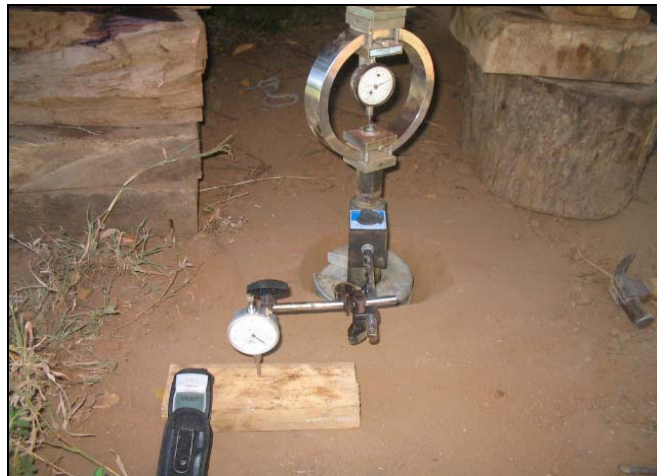
Figura 24. Montaje para el ensayo de CBR in situ: Cronometro, diales, anillo pistón y pesas de sobrecarga.
