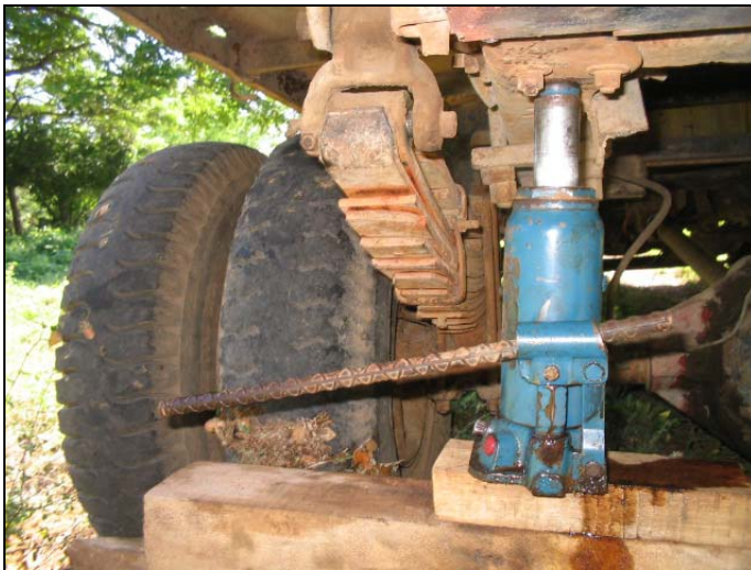
Figura 21. Estado de los muelles después levantar la camioneta
