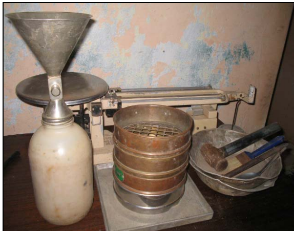
Figura 4. Equipo empleado en este proyecto para la determinación del ensayo de densidad de cono de arena
