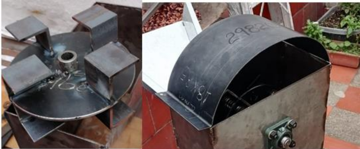
Figura 62. Caja, tapa de la caja y conjunto rotor con ángulos.
