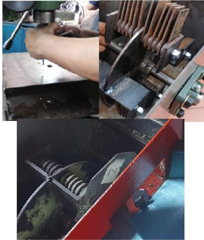
Figura 64. Perforaciones en la caja de trituración y montaje del elemento triturador.
