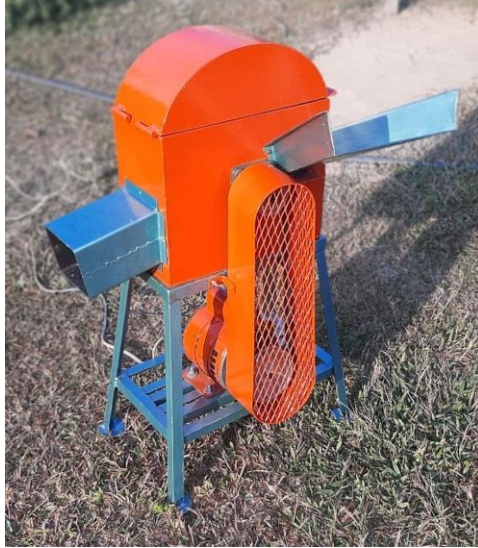
Figura 10. Prototipo final para la trituración de la hoja de la mata de piña.
