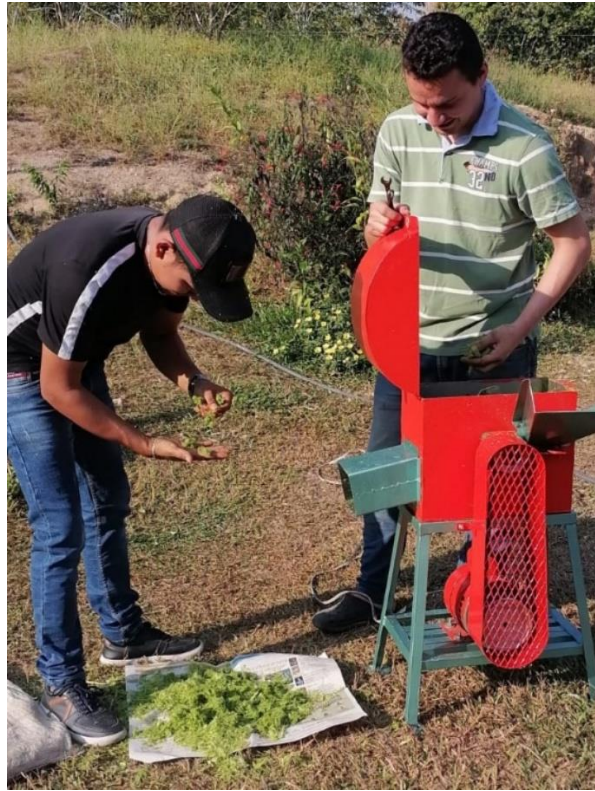
Figura 68. Puesta en marcha del prototipo y revisión de la materia prima triturada.
