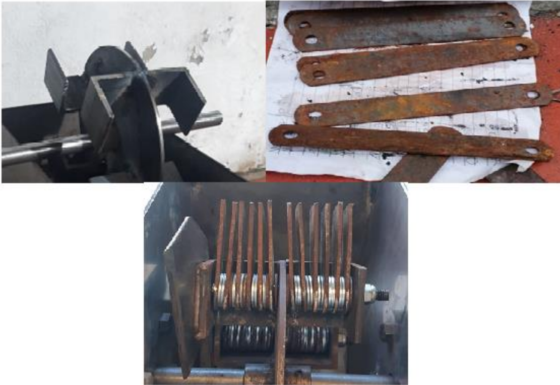
Figura 63. Eje del rotor, cuchillas para el corte y montaje del eje porta cuchillas.
