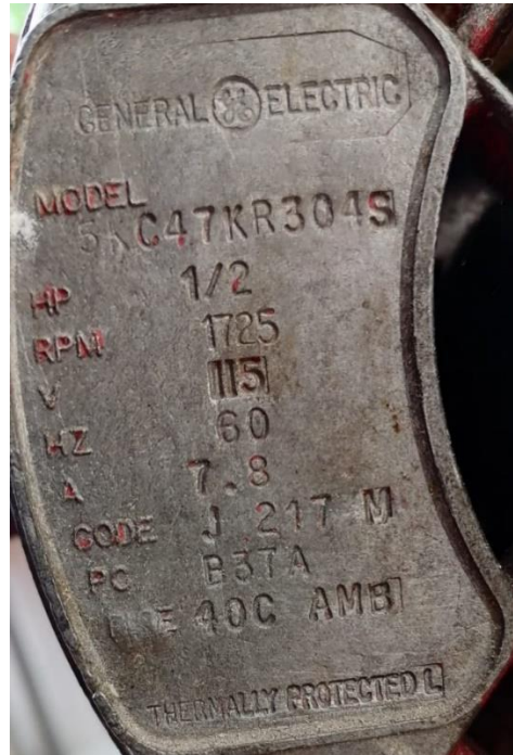
Figura 13. Características del motor utilizado en el prototipo.
