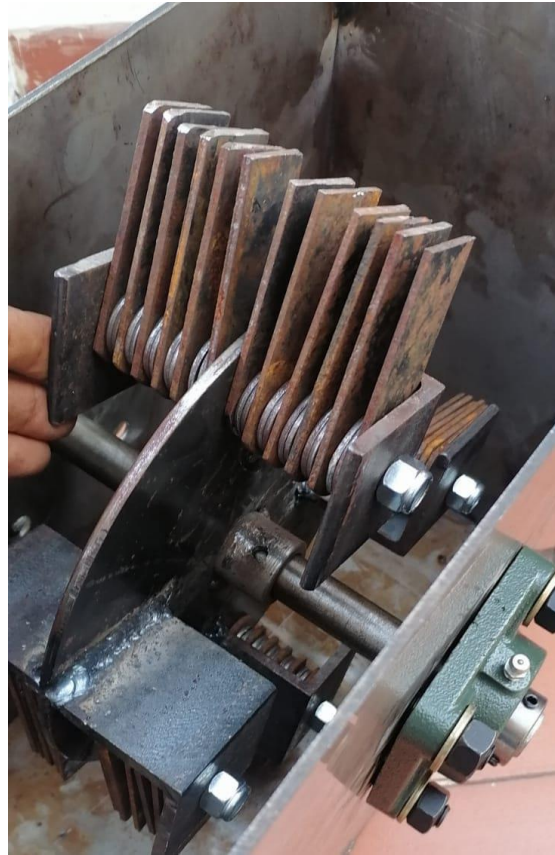
Figura 15. Ubicación de las cuchillas en los ángulos.
