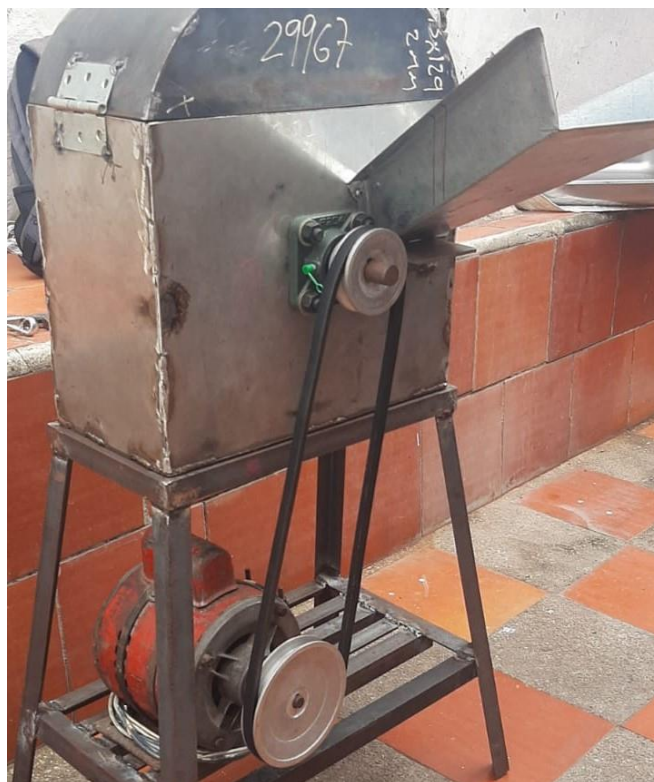
Figura 65. Transmisión de potencia por correas y tolva de ingreso de materia prima.
