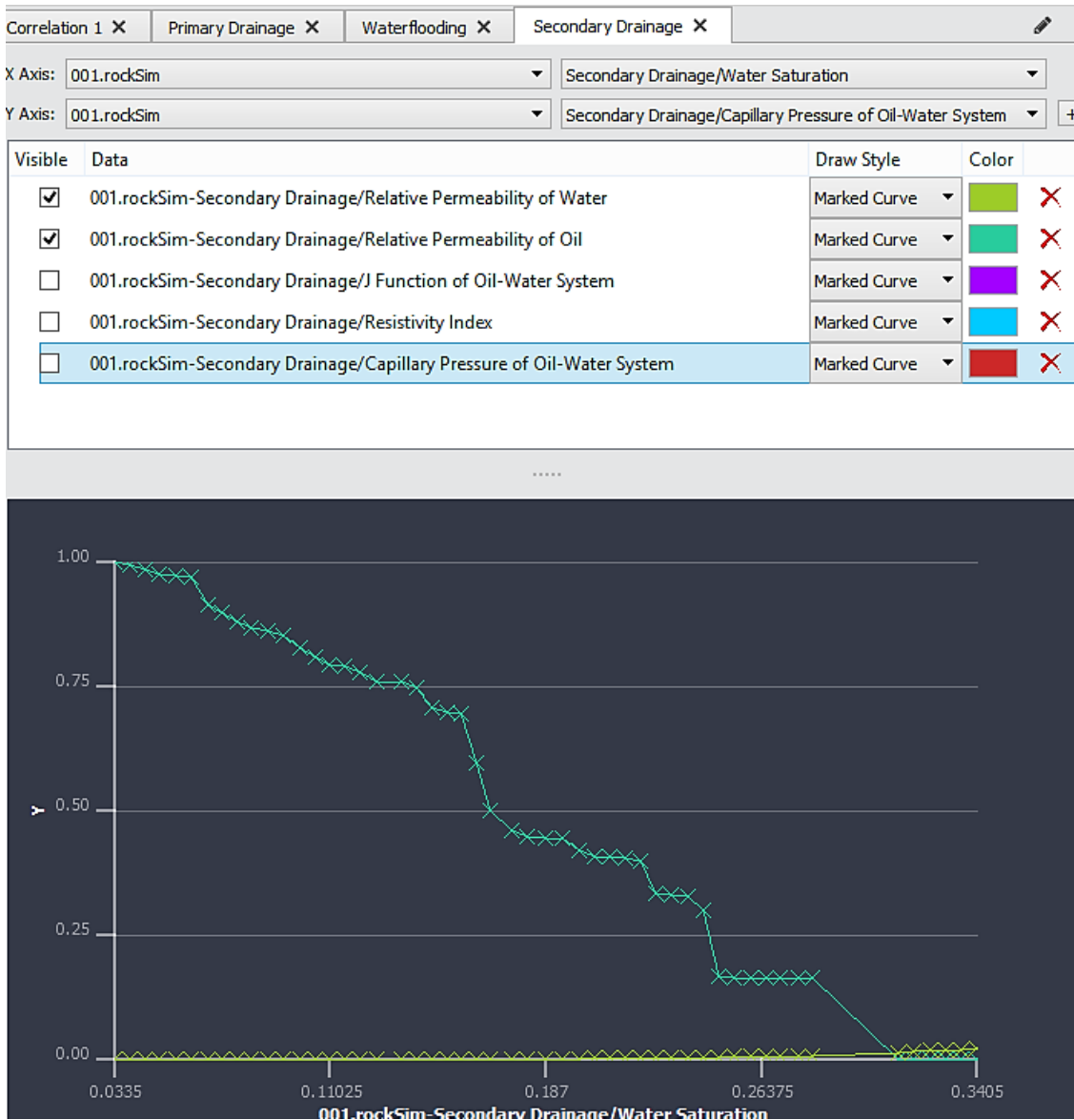
Figura 99. Permeabilidad relativa en drenaje secundario.
