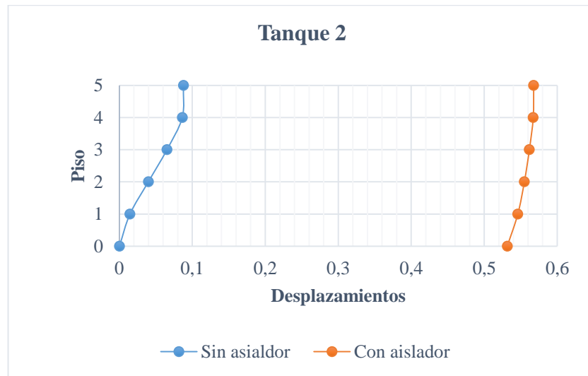
Figura 6. Comparación de desplazamientos horizontales para el tanque 2 con base fija y aislada.
