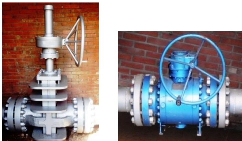
Figura 13. Válvula manuales de bola y compuerta
