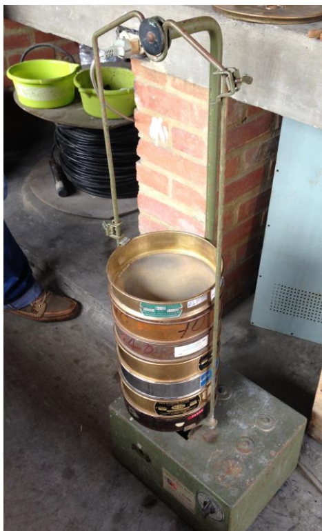
Figura 54. Tamiz utilizado en el laboratorio con las 6 mallas nombradas anteriormente
