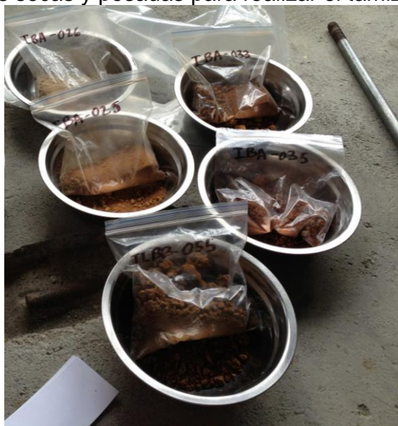
Figura 53. Muestras secas y pesadas para realizar el tamizado.
