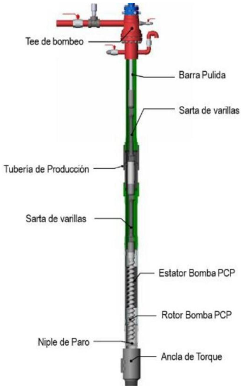
Fuente: WEATHERFORD. Módulo 1: Programa de entrenamiento en BCP. Bombas de cavidades progresivas (Componentes del sistema). 2018. Pág. 79.
