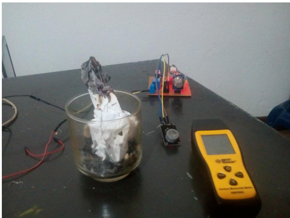
Figura 50. Prueba realizada con sensor MQ9 y medidor AS8700A de monóxido de carbono.
