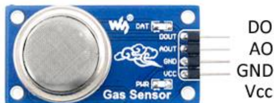
Figura 5. Vista frontal de un sensor de la serie MQ.
