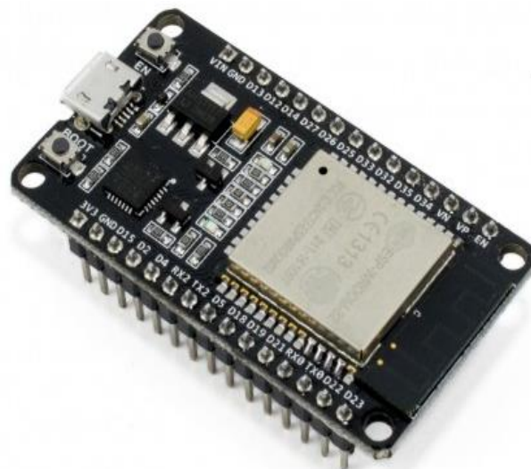
Figura 3. Tarjeta de desarrollo ESP32S.
