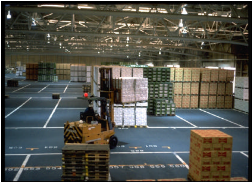
Figura 43. Almacenamiento en piso
