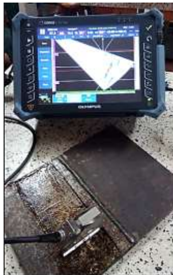
Figura 58. Inspección de fallos en soldadura
