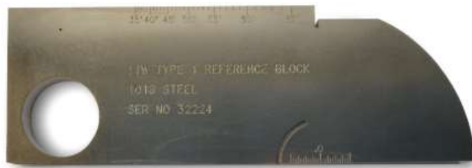
Figura 33. Probeta de calibración V1
