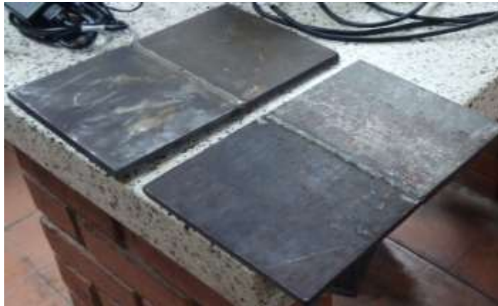
Figura 67. Cordón de soldadura en las placas de acero 1020 y 1045
