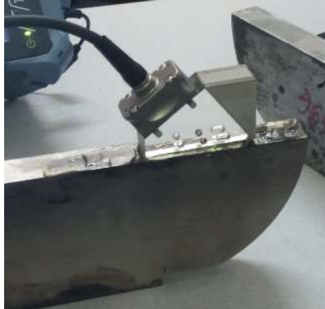
Figura 46. Calibración de velocidad
